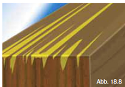
Abporen von rissigen Holzuntergründen
